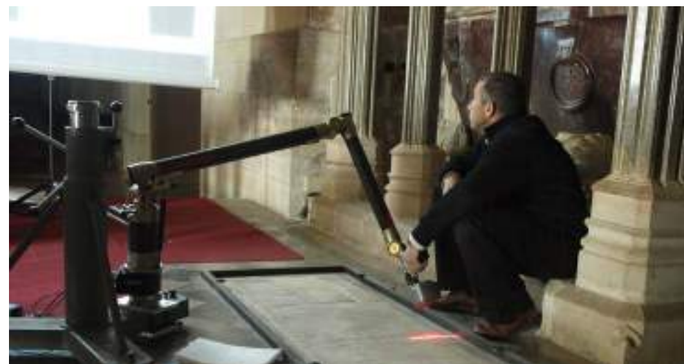
Treballs de lasermetria 3D sobre la làpida de Roger de Llúria
