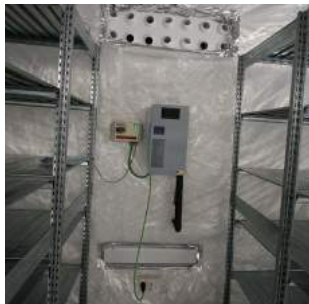
Equip portàtil d'extracció i filtració de gasos i vapors tòxics a l'àrea de treball, amb una filtració per sobre del 98 % Tlv
