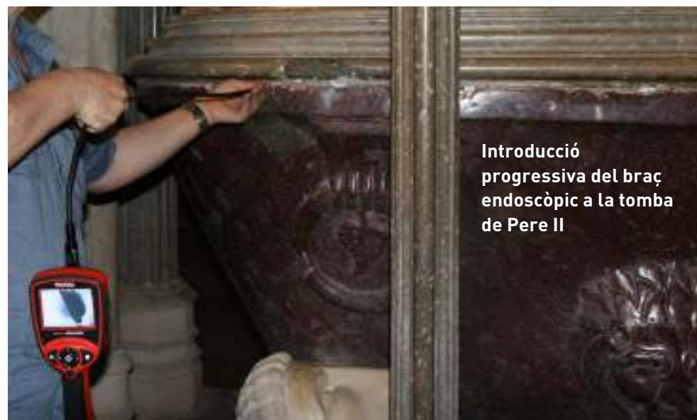
Treballs d'inspecció endoscòpica a través de la junta entre la banyera i la tapa
