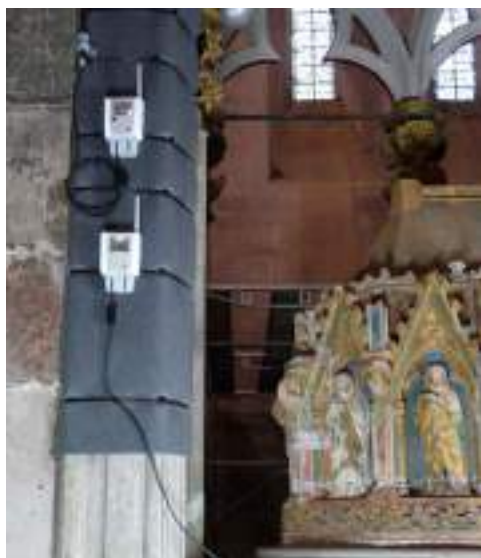
Dataloggers col·locats en una de les columnes del temple de la tomba de Pere el Gran
