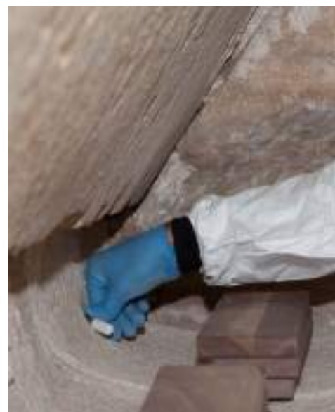
Posició del datalogger i la sonda a la tomba de Jaume II i Blanca d'Anjou
