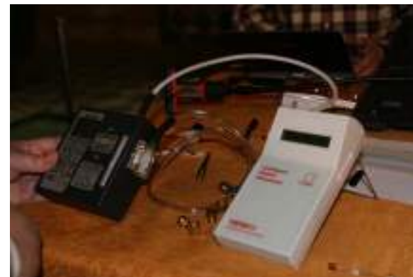
Calibratge de la bomba amb fluxòmetre
